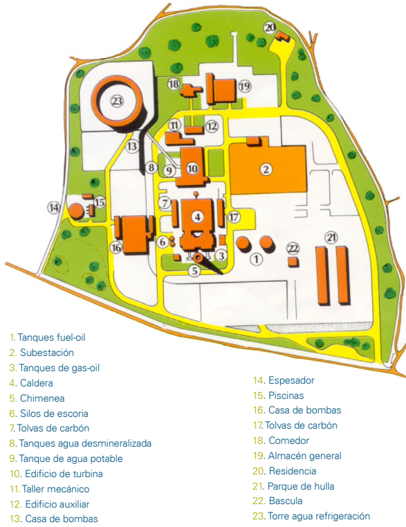
Ilustración 4. Diagrama de la implantación del proceso productivo en la Planta
