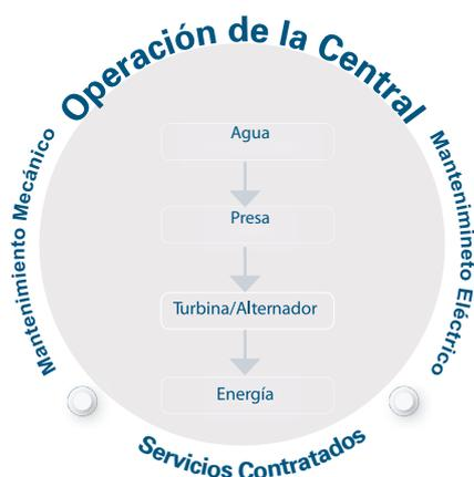
El fundamento de estas instalaciones se basa en transformar la energía potencial de la masa de agua retenida en una presa, en energía eléctrica. Para ello, el agua situada en el punto más alto (en la presa) se conduce hasta la turbina donde se transmite el movimiento a un generador, que lo transforma en energía eléctrica.
