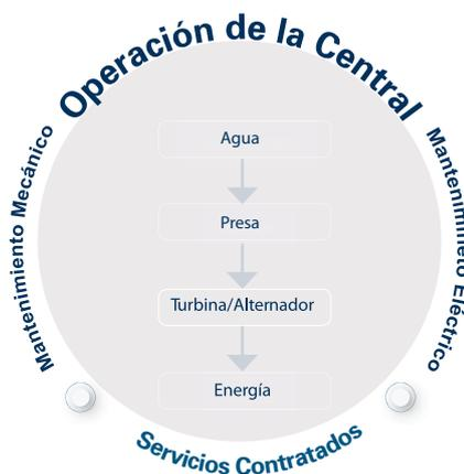
El fundamento de estas instalaciones se basa en transformar la energía potencial de la masa de agua retenida en una presa, en energía eléctrica. Para ello, el agua situada en el punto más alto (en la presa)
